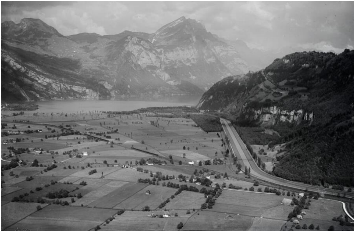
Molliser- bzw. Escherkanal: der 1811 als erster fertiggestellte 5 km lange Kanal des Linthwerkes. Aufgenommen 1925 von Walter Mittelholzer.
