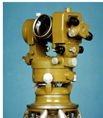
Wilds Theodolit Kern DMK3 (1939). Genauigkeit 0.1 sec.
