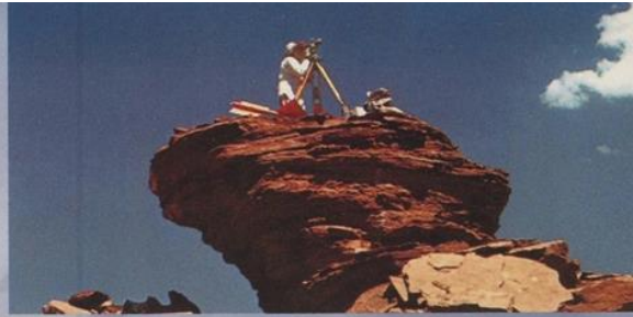
Oben: Brad Washburn von National Geographic 1970 mit Wild T3 bei der Grand-Canyon-Vermessung auf Dona Butte. Washburn lässt 1983 von Swissphoto mit einer Wild RC10 auch den Mount Everest überfliegen und 1987 in der Schweiz mit dem Stereoauswertegerät Wild A8 photogrammetrisch auswerten und kartieren (siehe Kartenausschnitt links unten). ((RE))
